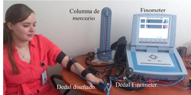
Fig. 2. Colocación del dispositivo diseñado y del Finometer en un sujeto.
