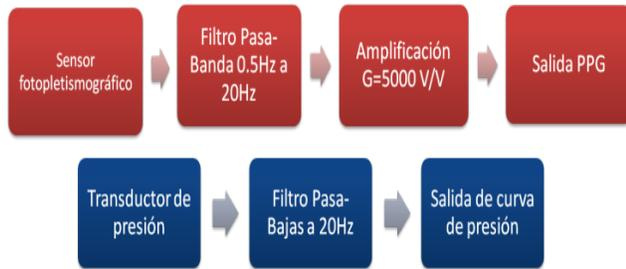
Fig. 1. Diagrama a bloques del dispositivo diseñado, en rojo el módulo de fotopletoisografía y en azul el módulo de medición de la presión.
