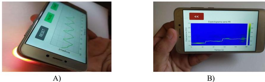
Fig. 4. Aplicación móvil desarrollada para Android. A) Ejemplo de adquisición de señal iPPG. B) Estimación de RR instantánea en la *app* para tres cambios de frecuencia (0.1, 0.2 y 0.3 Hz).
