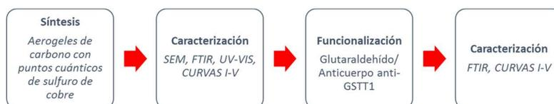
Fig. 1. Diagrama esquemático del procedimiento experimental.
