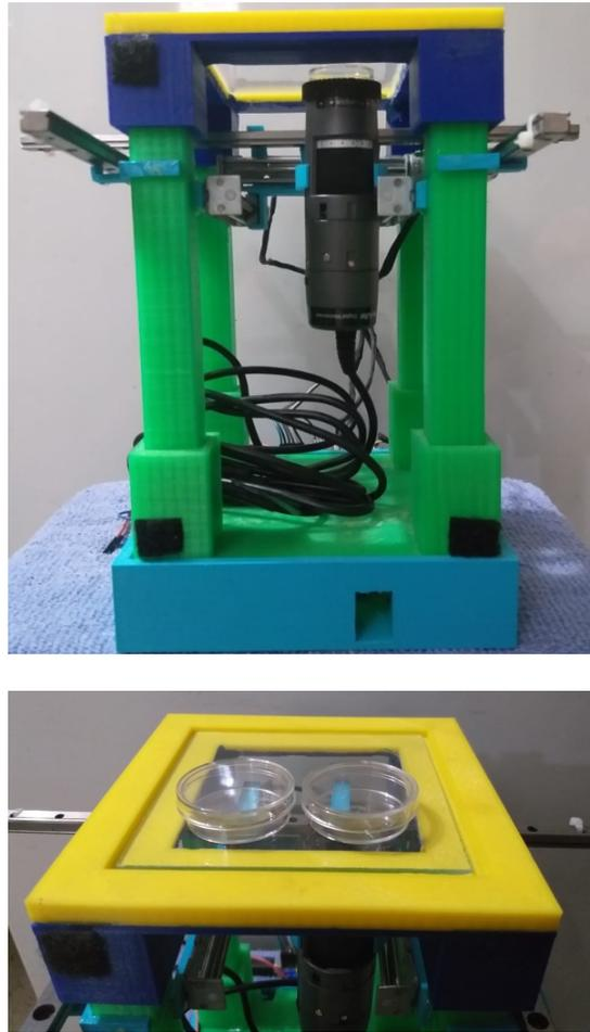
Fig. 5. Resultado de la impresión de la estructura del prototipo. (a) Vista lateral y (b) área efectiva de captura.
